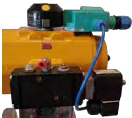
Pneumatische bediening met eindloopschakelaar doorverbonden met magneetventiel
